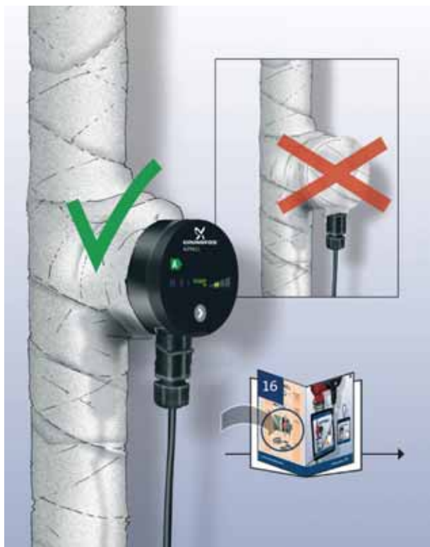
Fig. 5 Izolarea carcasei pompei
